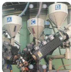
多层复合耐压胶管 生产设备
